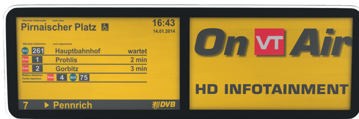
Mittels der APIX-2 Datenautobahn übertragen VIANOVA Systeme zwei unabhängige HD-Video-Bilder gleichzeitig über ein einzelnes Kabel mit 3 GBit/s (Bilder: VIANOVA).
