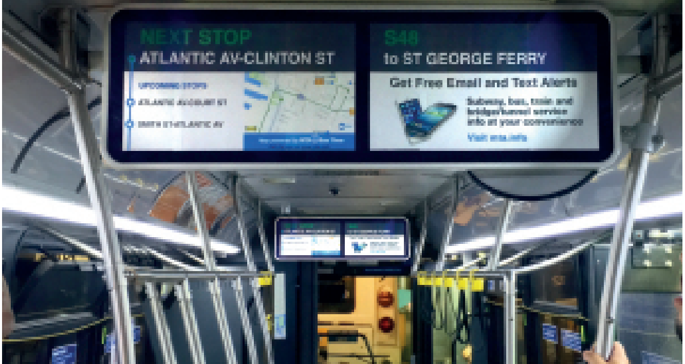
Bild 1. Mit drei Doppeldisplays an der Decke in den Gelenkbussen in New York ist die FGI und das Infotainment für jeden Fahrgast von allen Plätzen gut einsehbar (Werkbild VIANOVA).
