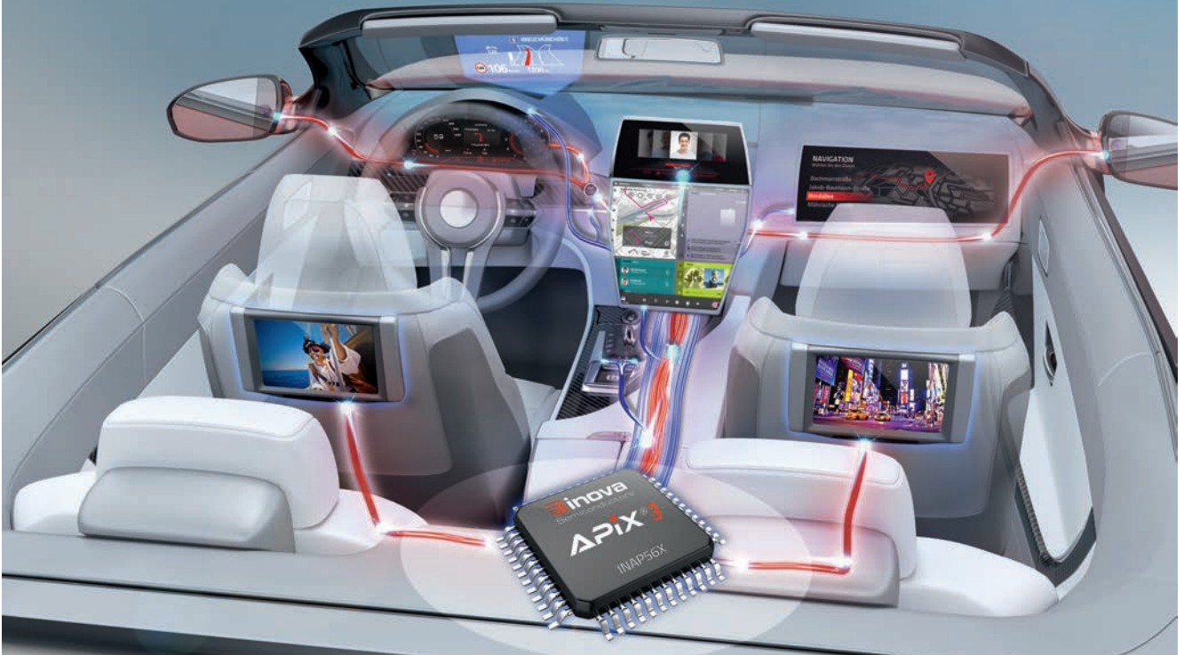
Bild 1 zeigt APIX als Nervenader aus Kupfer zur Verbindung aller Videosysteme im Automobil (Werksbild: INOVA Semiconductors).
